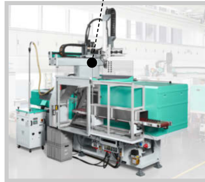
Spezielle Ausführung: MULTILIFT SELECT mit platzoptimiertem Aufbau.
