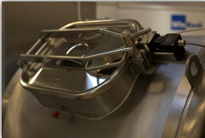
Abbildung 9 Abdeckung Mannloch mit Verschlusschraube und Sicherungsstift (rot)
