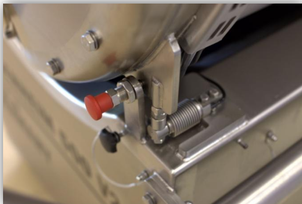
Abbildung 5 Wiegezelle ohne Abdeckung
